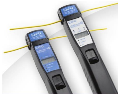
شکل ۱۱: دستگاه شناسایی فیبر نوری متشکل از تولید کننده سیگنال تن و تشخیص دهنده فیبر فعال [۱۷]
