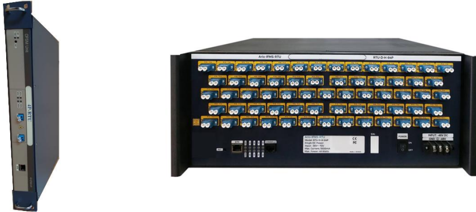
شکل ۴۲: نمای کلی دو مدل RTU (۶۴ و ۴ پورت) مانیتورینگ فیبر نوری شرکت آریونک [۲۵]
