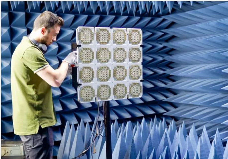
شکل ۷- آزمایش یک ساختار مربعی شکل از ماهواره BW ۳ در اتاق شیلد آنتن [۱۵]
